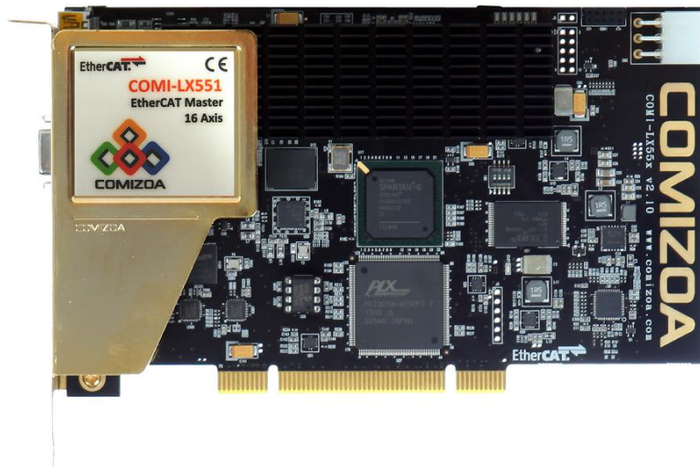
[그림 1-2] COMI-LX552 (32 축) / LX551 (16 축) / LX550 (8 축) Master Controller
